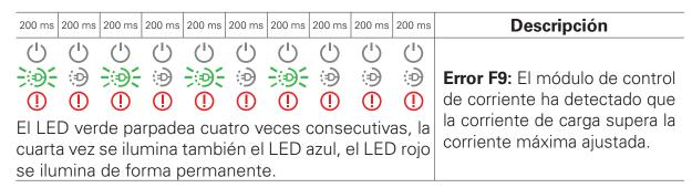
**Solución:** La Wallbox reinicia automáticamente el proceso de carga después de 60 segundos. Si se sigue repitiendo el fallo, debe comprobarse el vehículo: Póngase en contacto para ello con un taller cualificado.
