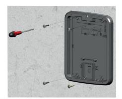
**NOTA:** Para tender la línea de alimentación desde atrás, primero debe introducir el cable a través de la abertura en el área de conexión en el tercio inferior de la placa de montaje y luego atornillarla.
