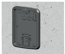
4. Taladre los orificios marcados (Ø 10 mm). Si es necesario, coloque los tacos suministrados para los tornillos de fijación.
