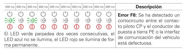
**Solución:** La Wallbox reinicia automáticamente el proceso de carga después de 60 segundos. Si se sigue repitiendo el fallo, diríjase al técnico electricista que ha efectuado la instalación para que compruebe el funcionamiento del cable de carga y de la Wallbox. Si durante la comprobación del cable de carga no se ha detectado ningún fallo, deberá revisarse el vehículo: Póngase en contacto para ello con un taller cualificado.
