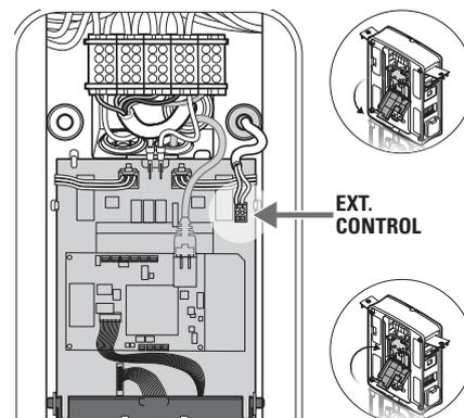
Dopo il collegamento elettrico della linea di comando deve essere attivata la funzione di spegnimento remoto tramite la **ABL Configuration App**. Si leggano a tal riguardo le sezioni da pagina 39.
