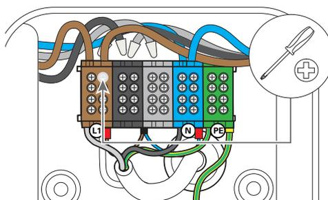
I punti di ricarica della Wallbox eM4 Twin sono ora allestiti elettricamente per l'impiego ad una fase. Oltre alla trasformazione elettrica, ora è tuttavia necessario allestire la Wallbox anche tramite la **ABL Configuration App** per l'impiego ad 1 fase. Si leggano a tal riguardo le sezioni da pagina 39.
